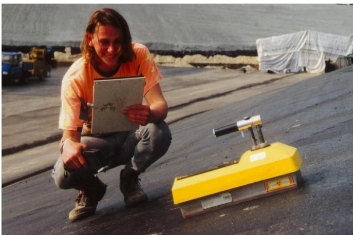
Abb. 3: Zerstörungsfreie Dichtebestimmung mit der Isotopsonde
