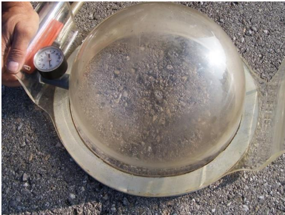
Abb. 1: Dichtigkeitsprüfung mit einer Vakuumglocke
