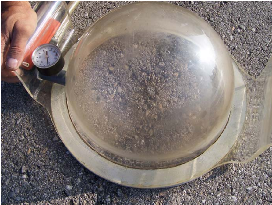
Abbildung 29: Dichtigkeitsprüfung mit einer Vakuumglocke
