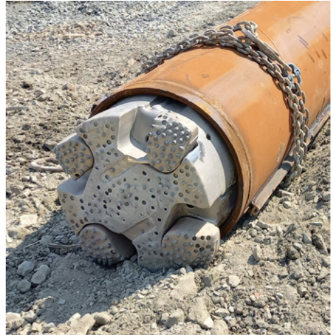
Abbildung 2-1: Bohrkronen des Imlochhammers
