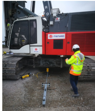
Abbildung 8: Leichte Probelastung bis 400 kN mit CMC-Gerät als Widerlager
