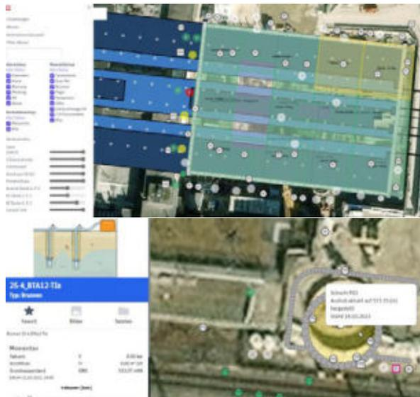
Abbildung 3-4: Zusammenführung von Daten aus dem Baubetrieb, der Wasserhaltung und dem Verformungsmonitoring in unterschiedlichen Ebenen.
