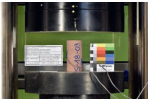
Abbildung 3-1: Sandstein: Prüfkörper Sst (A) 180300 mit Dehnungsmesstreifen
