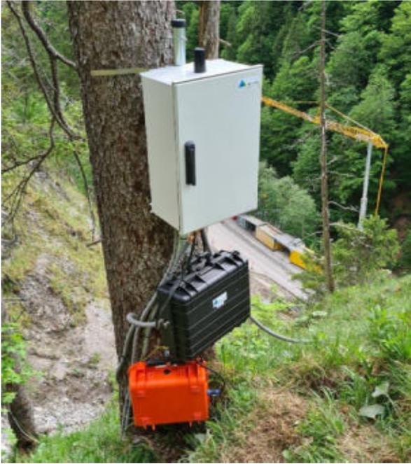
Abbildung 4-1: Die zentrale Datenerfassungseinheit wurde ca. 50 m oberhalb der Baustelle montiert.
