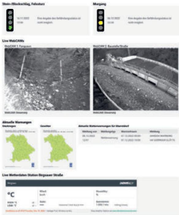
Abbildung 4-4: Darstellung der aktuellen Gefahrenlage sowie wichtiger weiterer Informationen zur Bewertung der Gefahrensituation im Webportal.
