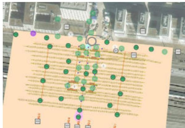
Abbildung 3-3: Geomonitoring am Rettungsschacht 3 zur Überwachung von Baugrundverformungen.
