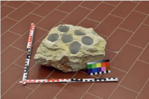
Abbildung 2-1: Kalkstein: Probe mit Kernbohrungen
