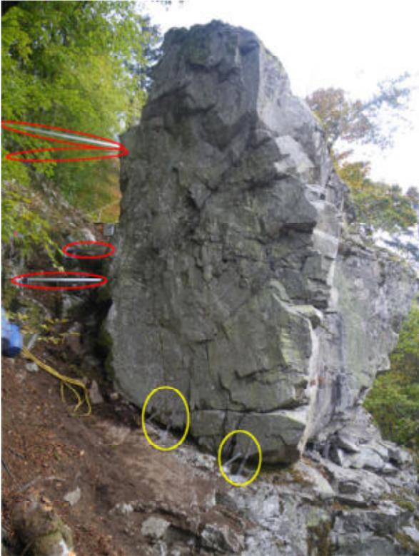
*Abbildung 5-1: Ca. 250 m<sup>3</sup> großer Felsturm mit installierten Extensometern (rot umrandet) und Felsspielen (gelb umrandet) zur Überwachung von Bewegungen (Arbeitsschutz) im Herbst 2020*
