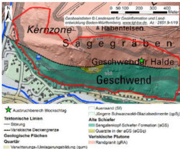
Abbildung 2-1: Ausbruchsbereich des Blockschlags sowie geologische Verhältnisse im Untersuchungsgebiet (rot umrandet)
