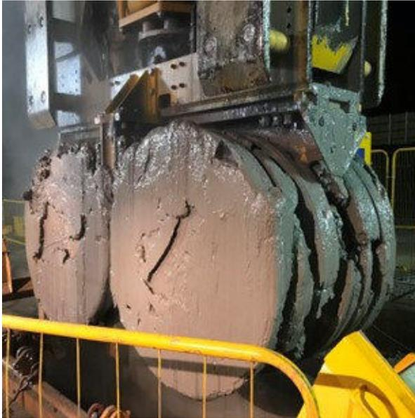
Abbildung 3-1: völlig verklebtes Fräsrade (BAUER Spezialtiefbau)
