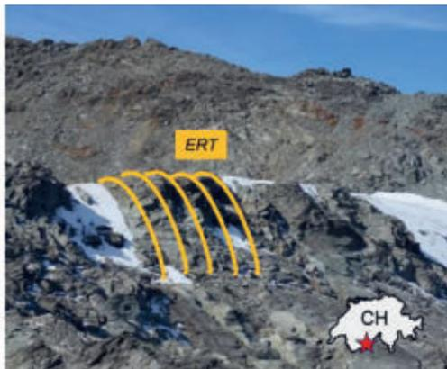
Abbildung 2-1: Anordnung der elektrischen Widerstandsmessungen (ERT) entlang von fünf parallelen Profilen am Steintälli-Grat.
