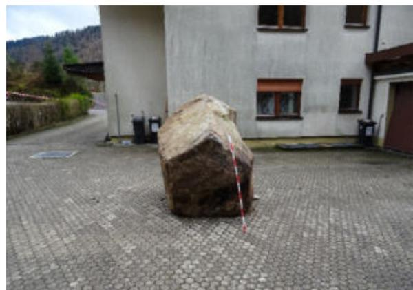
Abbildung 1-1: Abgestürzter Block im rückwärtigen Hofgelände eines Wohngebäudes in der bebauten Ortslage von Todtnau-Geschwend, Lkr. Lörrach (Aufnahmedatum: 08.03.2019; Länge des Bezugsmaßstabes: 120 cm)
