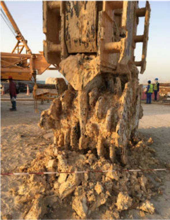
Schlitzwandfräse nach Verwendung in einer Polymer-Stützsuspension
