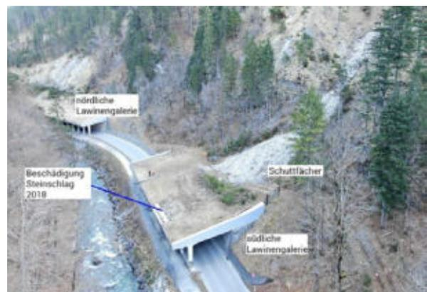
Abbildung 1-1: Drohnenaufnahme der südlichen Lawingalerie vor Durchführung der Baumaßnahme.
