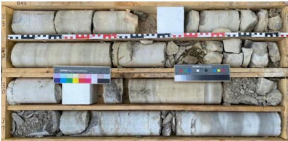
Abbildung 4: Bohrkerne aus dem Bereich der Meißner-Formation.
