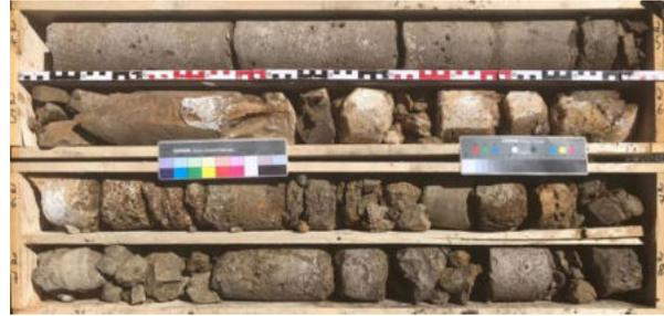
Abbildung 6: Bohrkerne aus dem Bereich der Trochitenkalk-Formation.
