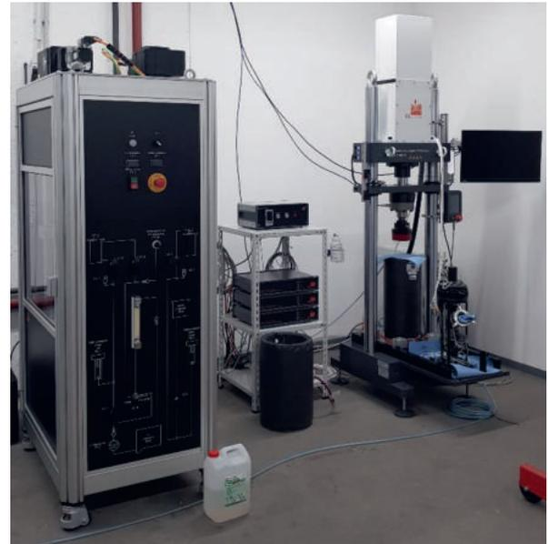
Abbildung 2: Aufbau der Prüfeinrichtung mit Schrank für Hydraulikpumpen (links), Technik des Kontrollsystems (mittig), Belastungsrahmen der Triaxial-Druck-Maschine und die Druckzelle (rechts).
