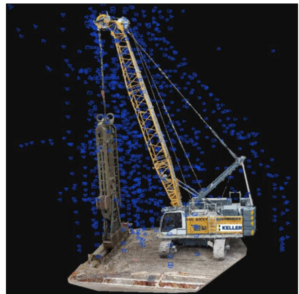
Abbildung 3.1 Erstellung von Einzelbildern; jede Aufnahme-Position ist hier blau dargestellt (Schmidt, 2023)
