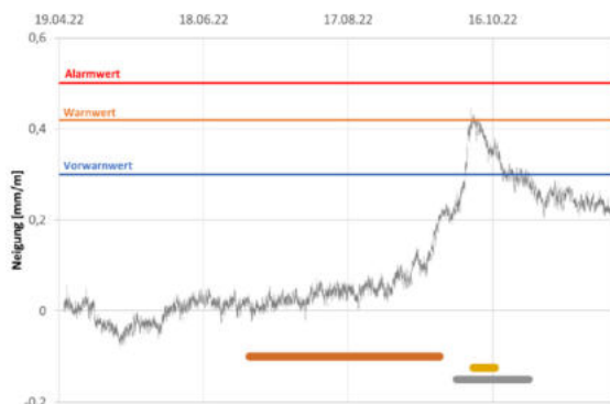
Abbildung 5: Zeitlicher Verlauf Neigung des östlichen Windverbands. Positive Neigungen bedeuten Verkipfung nach Norden. Als brauner Balken ist der Vortrieb des südlichen Aufweitungsbauwerks, grau der Vortrieb des südlichen Verzweigungsbauwerks Pfaffensteigtunnel dargestellt. Der gelbe Balken markiert den Bereich mit eingeschränkter Vortriebsgeschwindigkeit.
