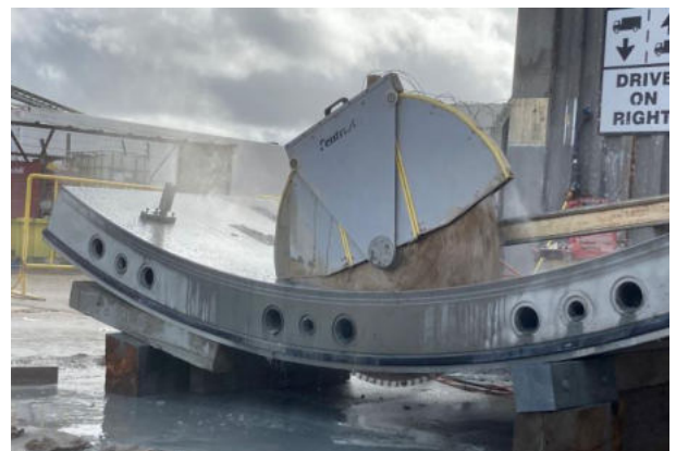
Abbildung 2-3: Sondersegment wird zu Testzwecken aufgeschnitten
