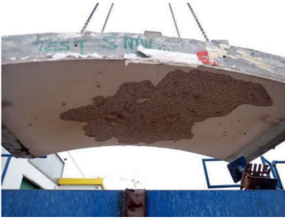
Abbildung 2-4 Sondersegment nach Großbrandversuch (EBA-Brandlastkurve) bei MFPA Leipzig
