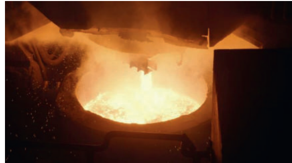
Abbildung 2-2: Schmelzvorgang von Schrott durch Lichtbogen im Elektroofen der Lech-Stahlwerke LSW (EAF)
