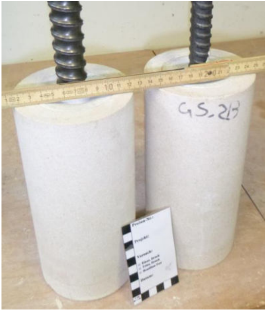
Abbildung 3-1: Probenkörper für Versuche. Links Ischebeck Titan 30/11 und rechts GEWI d = 20 mm.
