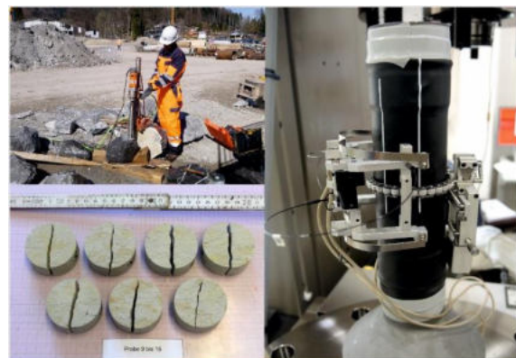
Abbildung 2-1: Symbolische Darstellung des Tätigkeitsspektrums des AK 3.3, im Uhrzeigersinn: Probenahme im Gelände, Triaxialversuch in der Prüfanlage und Probekörper nach Durchführung von Spaltzugversuchen.
