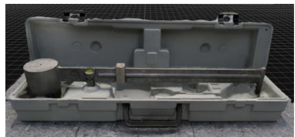
Abbildung 4.4 3D-Modell einer Bentonitwaage (Matar, 2023)
