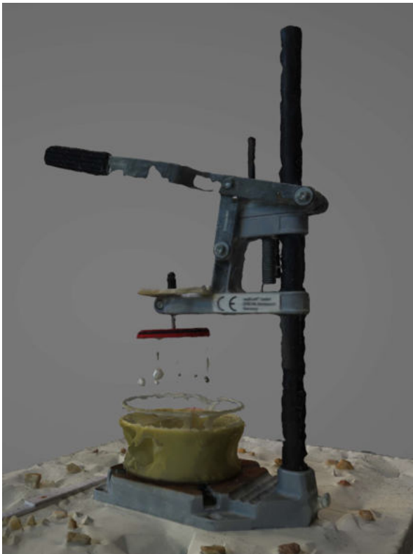
Abbildung 4.5 3D-Modell eines Kugelharfenversuchs (Matar, 2023)
