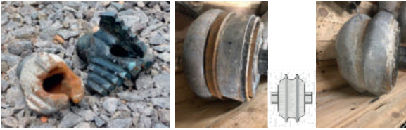
Abbildung 4.2: Verschleiß an einem Stufenmeißel in hoch abrasivem Moselschotter (links), Verschleiß an Schneidrollen (rechts, Bild: Wayss & Freytag)
