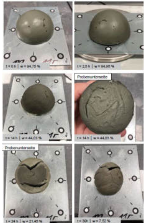
Abbildung 4-1: Bilderstudie zum Schrumpfverhalten einer Probe aus 100% Tarraston
