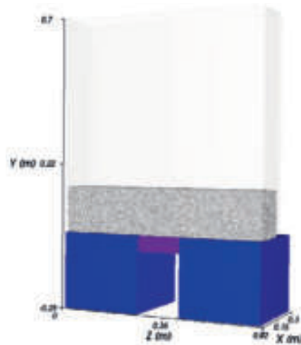
Abbildung 2-5: DEM-Trapdoor-Modell für das niedrigste Einbettungsverhältnis i=1
