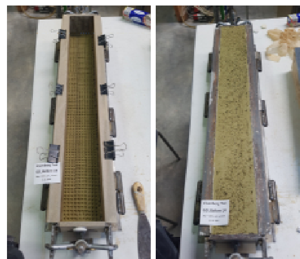
Abbildung 3-2: Erste und letzte Lage beim Einbau des GD Tons
