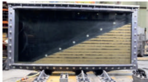
Abbildung 2-4: Böschungprofil des Versuchs 7 vor der dynamischen Anregung.
