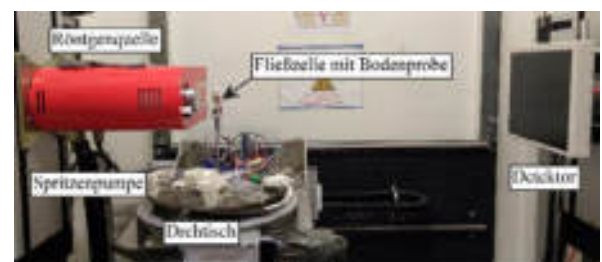
Abbildung 3-1: Versuchsaufbau zur Untersuchung des Wasserretentionsverhaltens mittels CT, hier am Laboratoire 3SR der Université Grenoble Alpes
